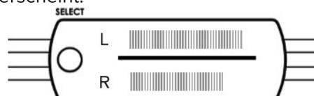
Die Ausgangsleistungen des linken und rechten Kanals werden einzeln angezeigt, oder, falls sich der Verstärker im Mono-Modus befindet, zeigen beide Balken die gleiche Aussteuerung an.
