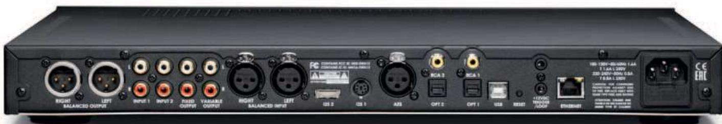
Die beiden I<sup>2</sup>S-Schnittstellen, hier in Gestalt einer HDMI-Buchse und einer Mini-DIN-Buchse, sind nur das womöglich kaum benötigte Tüpfelchen auf dem i eines gewaltigen Anschlussangebots. Bluetooth und WLAN stehen ebenfalls zur Verfügung.
